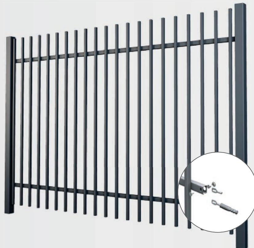
Die Segmente OPO 251 sind Industrie-Zaunfelder aus geschlossenen Profilen 25 x 25 [mm], per Überblattung an die Traversen aus geschlossenem Profil 40 x 27 [mm] verbunden.
