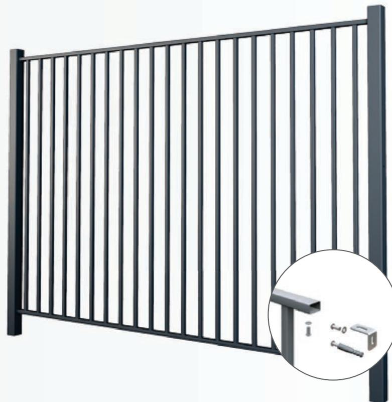
Die Segmente OPO 253 sind Industrie-Zaunfelder aus geschlossenen Profilen 25 x 25 [mm], per Überblattung an die Traversen aus geschlossenem Profil 40 x 27 [mm] verbunden.
